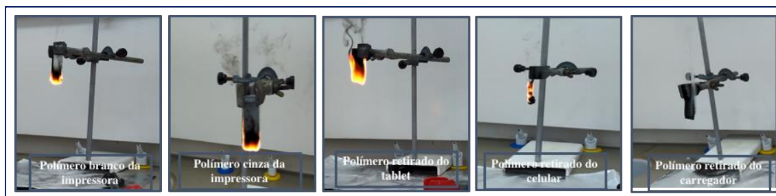
Figura 3: comportamento dos polímeros testados durante a queima
